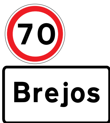
FIGURA 16 Exemplo de sinalização de atravessamento com 70 km/h
