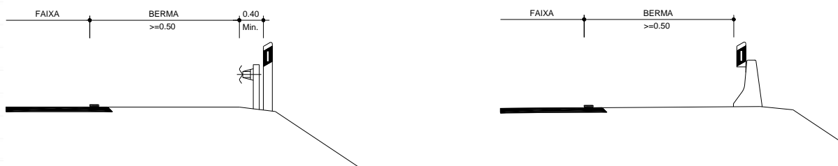
Figura 3. 10 - Delineadores - colocação transversal
