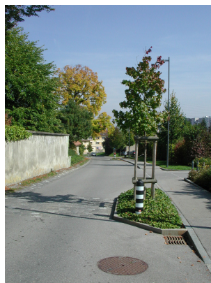
Figura 40 – Exemplo de estreitamento lateral, Givisiez, Suíça
