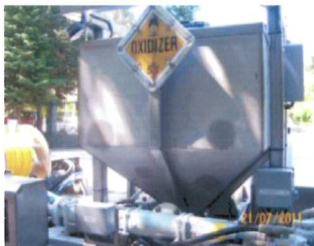
MEMU – Vista traseira onde se identificam o reservatório da matéria oxidante, o enrolador da mangueira, a sinalização e parte dos comandos.
