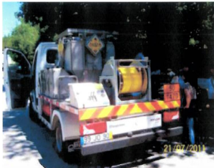
MEMU – Vista traseira onde se identificam o reservatório da matéria oxidante, o enrolador da mangueira, a sinalização e parte dos comandos.
