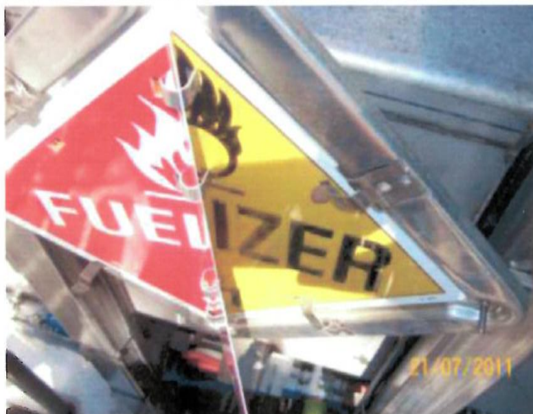
Pormenor da intermutabilidade da sinalização do reservatório (placas etiquetas). Os reservatórios podem transportar matérias das classes 3 (líquidos inflamáveis), 5.1 (comburentes), 6.1 (tóxicas), e 8 (corrosivas).
