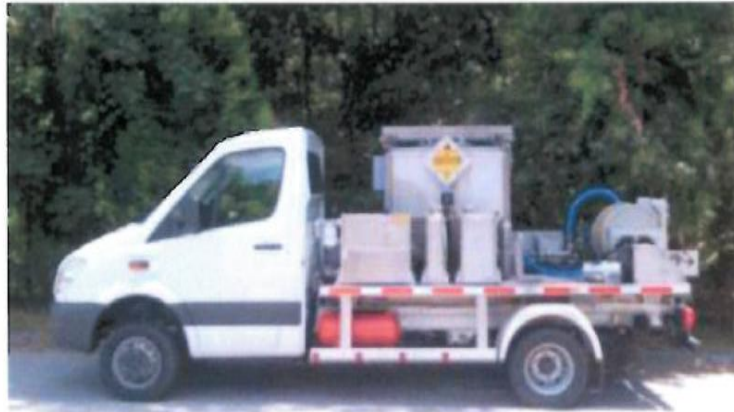
Vista geral do MEMU. Esta unidade não possui compartimento para transporte de explosivos.
